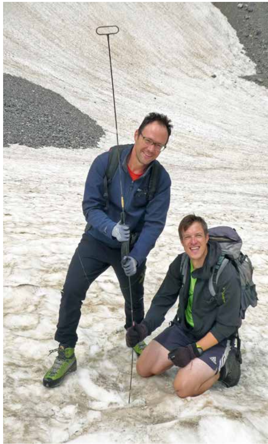
Gerhard Hohenwarter jun. (knieend) und Martin Ladstätter mit einer Lawinensonde beim Messen der Dicke der Schneedecke, die am Gletscher liegt
